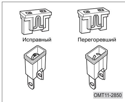
Если не работают фары или другое электрооборудование, проверьте предохранители. Если перегорел любой предохранитель, его следует заменить. Узнать расположение предохранителей можно в разделе «Блок предохранителей» данной главы.
