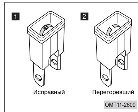
5. Заменяйте перегоревшие предохранители новыми предохранителями номиналом, указанным на крышке блока. Если предохранитель нужного номинала отсутствует, то можно воспользоваться предохранителем «Radio» (Радиоприемник) или «Ciga-rette lighter» (Прикуриватель), которые не влияют на работу автомобиля, и используйте его при совпадении номинала.
