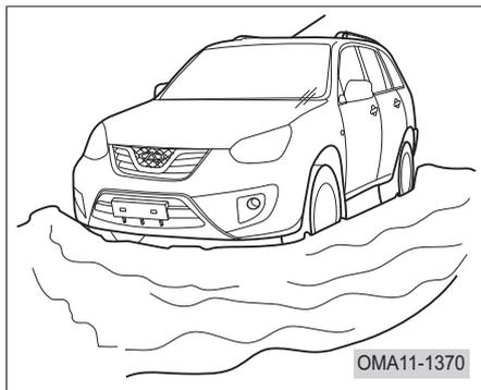
Если преодоление водного препятствия неизбежно, проверьте его глубину и двигайтесь медленно и осторожно.
